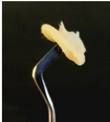
Fig. 1 - Composite nanohíbrido con las fibras de vidrio incorporadas.
