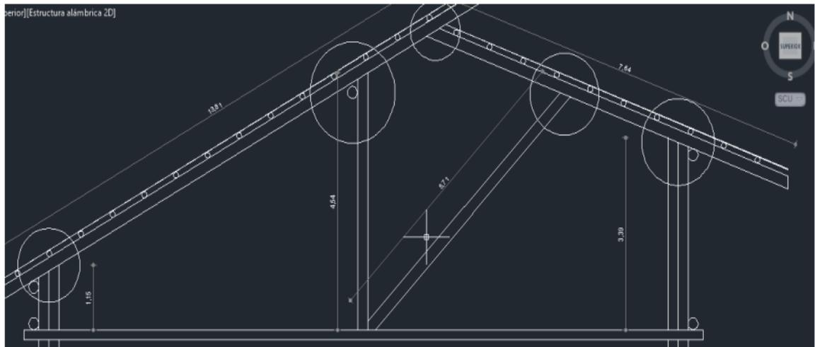
Figura 1: Nudos estructurales para la aplicación de la carga vertical.
